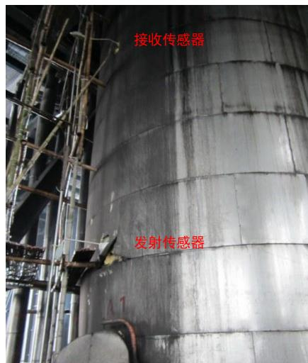
图 18 鼓泡塔液位检测工业装置实物图
