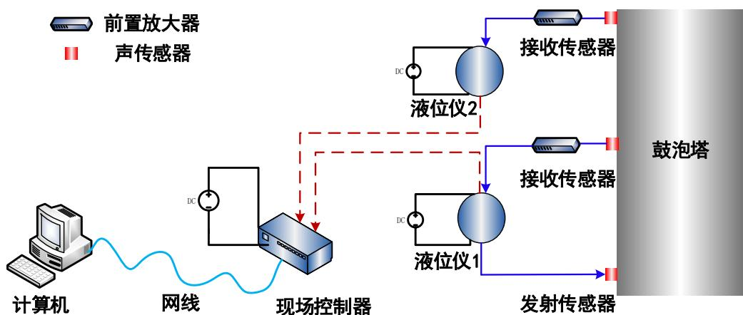
图 24 鼓泡塔超声波液位检测示意图
