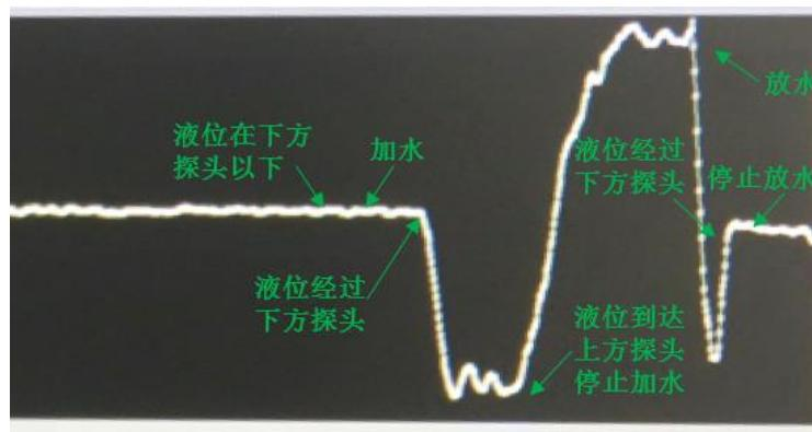
图 9 动态液位（加水、放水过程）测量时接收信号幅值随时间的变化（截屏图）
