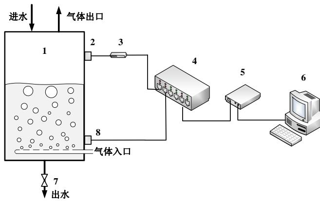
1-液体储罐+鼓泡； 2-接收传感器； 3-信号放大器； 4-超声波收发模块；
