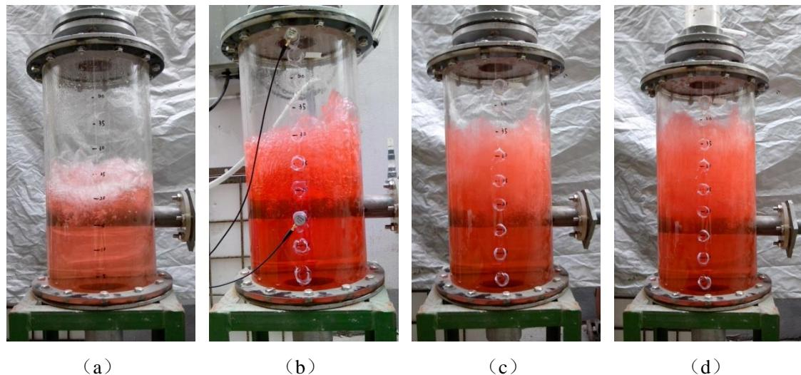
图 10 鼓泡塔“拟稳态”液位测量实物图
