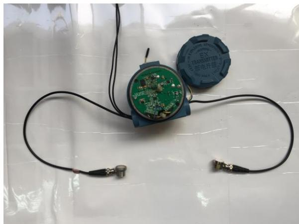
图 23 超声波液位检测仪样机实物照片
