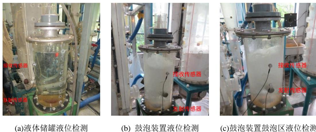
图 7 超声波液位检测实验装置实物图
