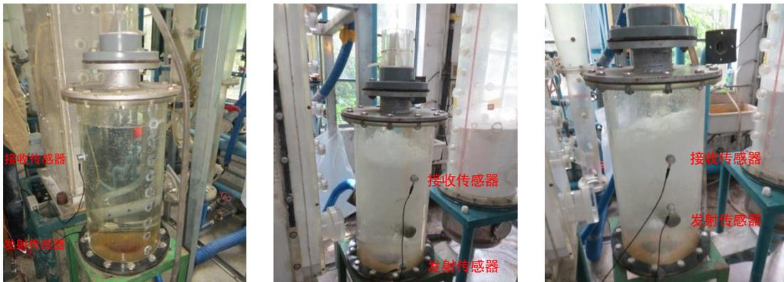
(a)液体储罐液位检测
