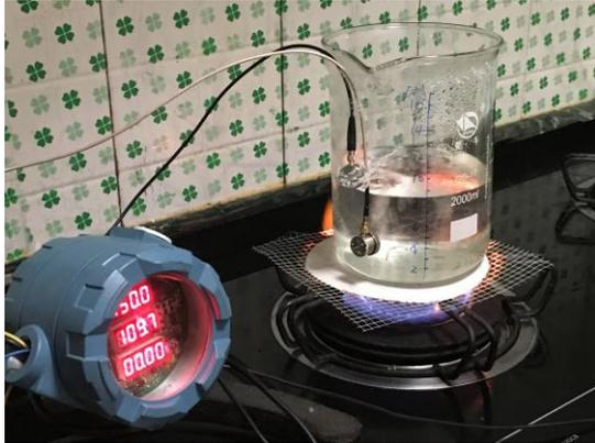
图 21 小型容器沸水液位测量实物图
