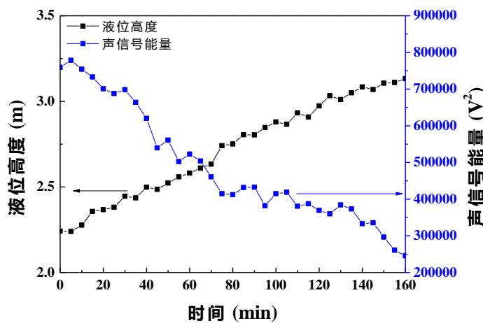
图 19 液位高度与超声波能量之间的关系
