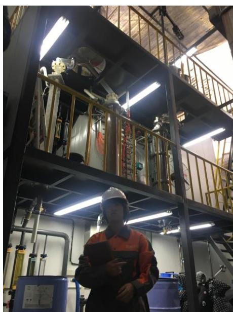
(c) 制备清洁柴油的加氢反应冷模装置
