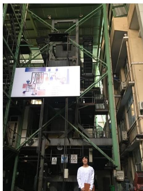
(d) 制备醋酸的射流反应器
