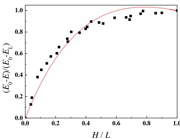
图 17 超声波液位检测仪和钢尺实测液位的对比
