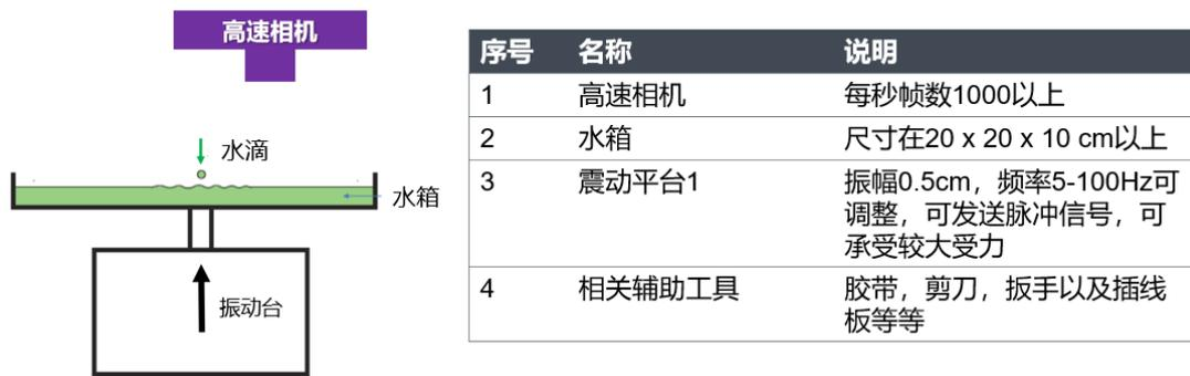
图 2. 简易机械震动平台示意图。右表给出了搭建该系统所用到的元件。
